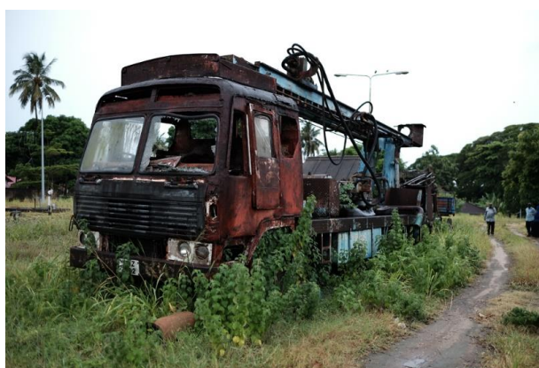
写真 2.1 Ashok Leyland ロータリータイプ井戸掘削機
