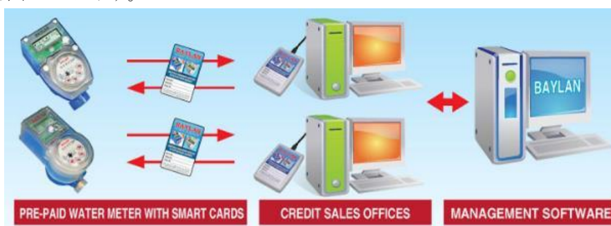
図 2.41 RIWSSZ での調達が想定されるプリペイド式メーターシステム
