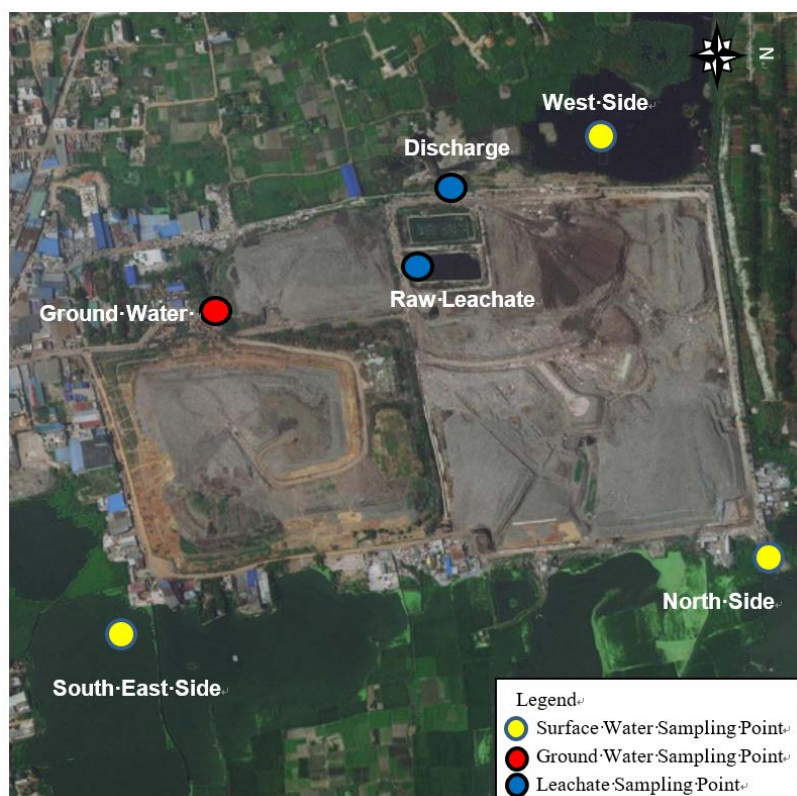
図 2-23 マトワイル処分場における水質モニタリング実施箇所
