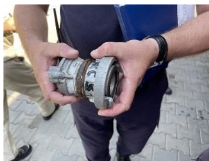
Foto 2-2 Adaptor care convertește forma de bază pentru compatibilitate dintre standardul GOST și standardul Storz (În posesia GIES)
