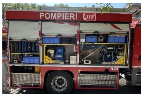
Photo 2-3 Dulapuri pentru depozitare în mașini de pompieri existente dotate cu obloane din aluminiu
