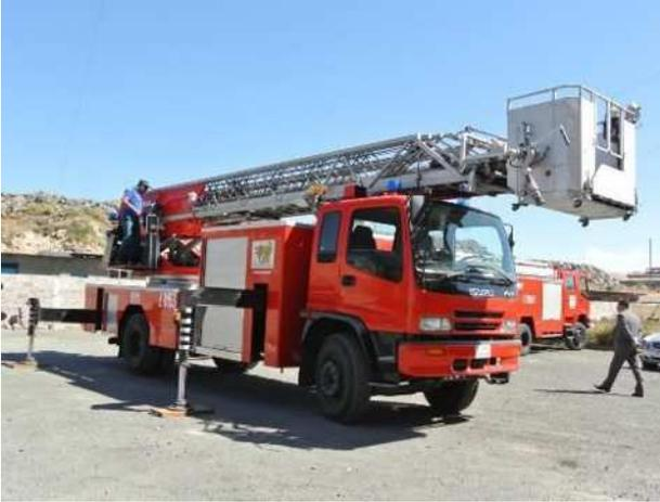
日本の消防車両メーカーが類似案件にて納入した「はしご車」。本プロジェクトで整備計画している「はしご車（30m クラス）」と類似したモデルである。
