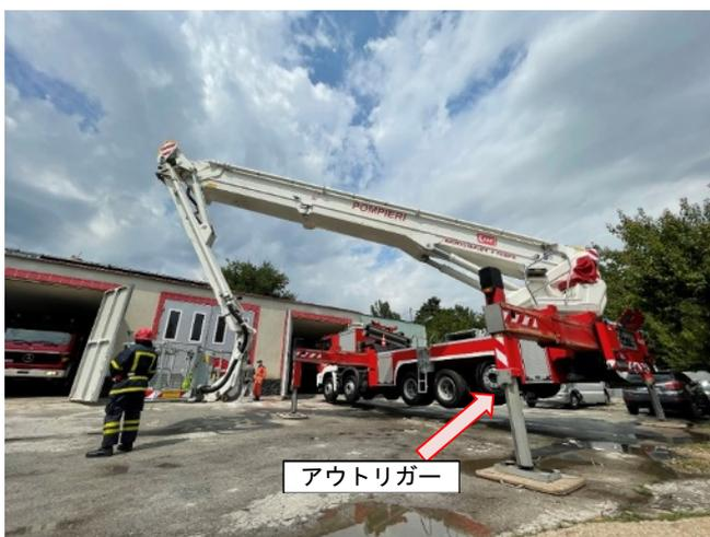
写真 2-5 キシノウ市の資金により調達されたイギリスのBRONT社製屈折式はしご車
