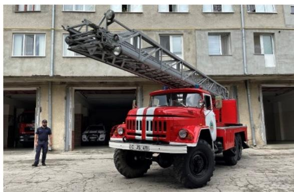
写真 2-6 バスケットが装備されていない旧ソ連製はしご車(30m)
