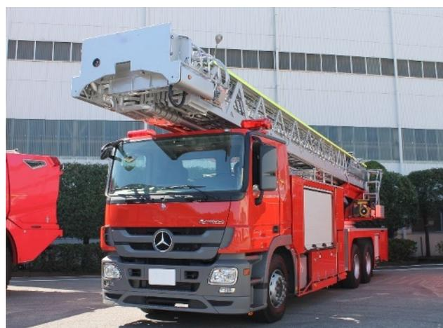
日本の消防車両メーカーが、ヨーロッパ製のシャシに「はしご車（50m クラス）」として艤装した例。
