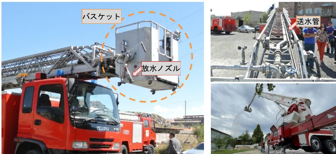
写真 3-3 放水ノズルとバスケットからの放水の様子
