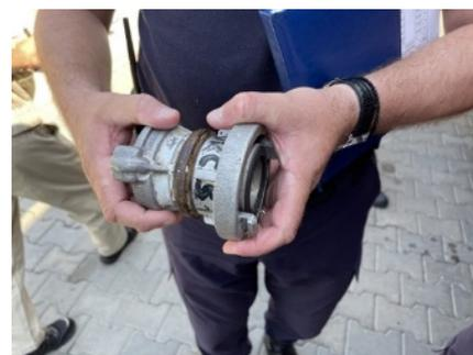
GOST 規格と Storz 規格の互換性を保つための口金形状を変換するアダプタ (GIES 所有)
