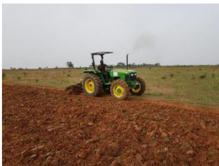
ディスクプラウによる耕起作業（左）とディスクハローによる砕土作業（右）
