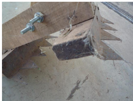
鋸状の鉄板で田面表層部を掻きむしるが木が厚いため手押し抵抗もある。
