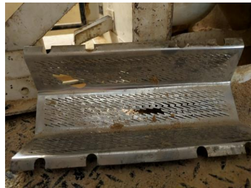
写真 4-15 破損した精米部のスクリーン
