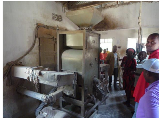
写真 5-7 上記写真 5-6 の製粉所にあるワンパス式糲摺り精米機
