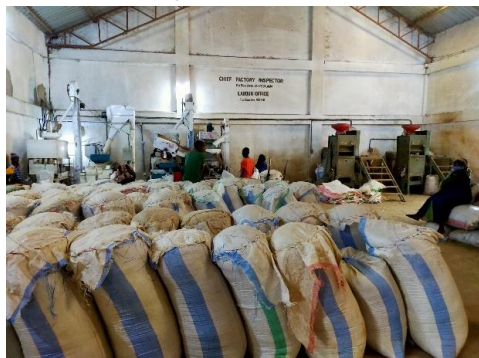
右に 2 台のワンパス式粃摺り精米機がある。
