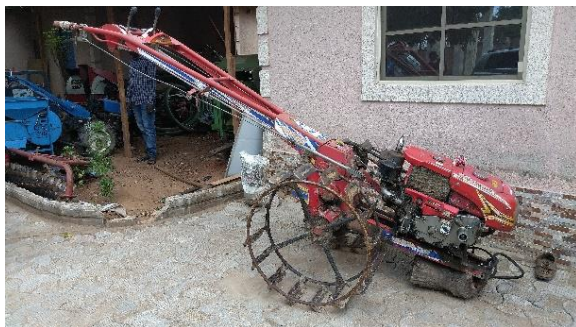
写真 4-7 パキスタン製耕うん機と牽引式の代掻きローター
