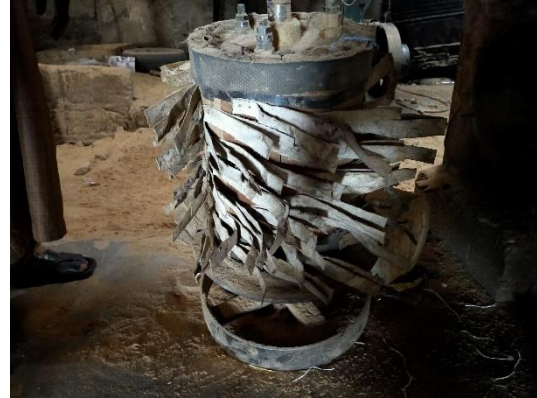
白米表面の糠粉を落とす研米装置。エンゲルバーグ機の下部に取り付けられる。
