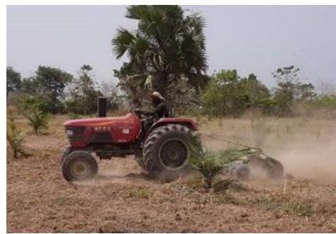
ディスクプラウによる耕起作業（左）とディスクハローによる砕土作業（右）
