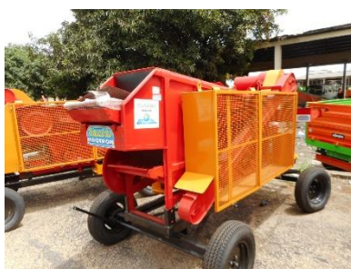
ブラジル製脱穀機、扱ぎ歯は帯鋼、揺動シーブで精選される
