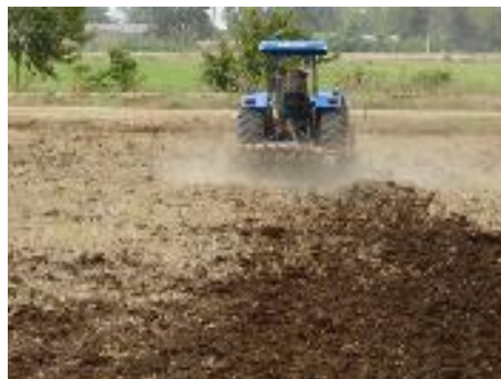
写真 3-4 ディスクハロー (Baldan) による耕起作業、その後乾田直播 (KIS) 出所：調査団撮影
