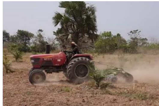
写真 4-1 ディスクプラウによる耕起作業（左）とディスクハローによる砕土作業（右） 出所：NCAM 提供
