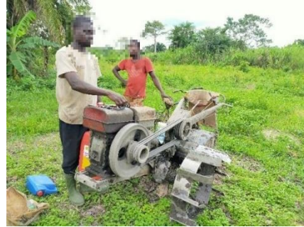
燃料補給中の耕うん機（中国製）、ホッパー式水冷エンジン
