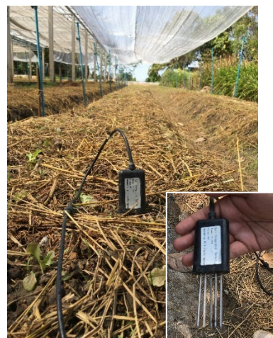
土壌分析センサー。1つのセンサーに5つのピンが付帯しており、pH、NPK、土壌水分、温度、ECを常時計測可能。
