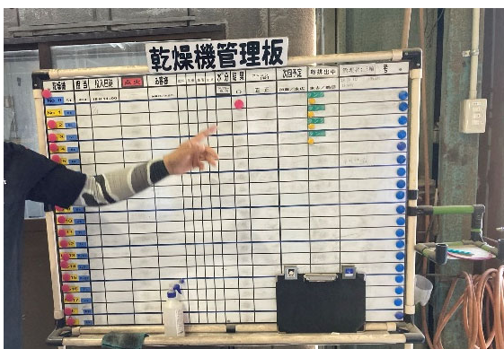
【国内①】 カイゼン手法を活用する農業生産者 (A-05) (愛知県) では、機械の管理版、粉袋用ラベル、従業員の多能工管理表等を用いて「見える化」とともに、小集団活動によってボトムアップでカイゼンを継続している。
