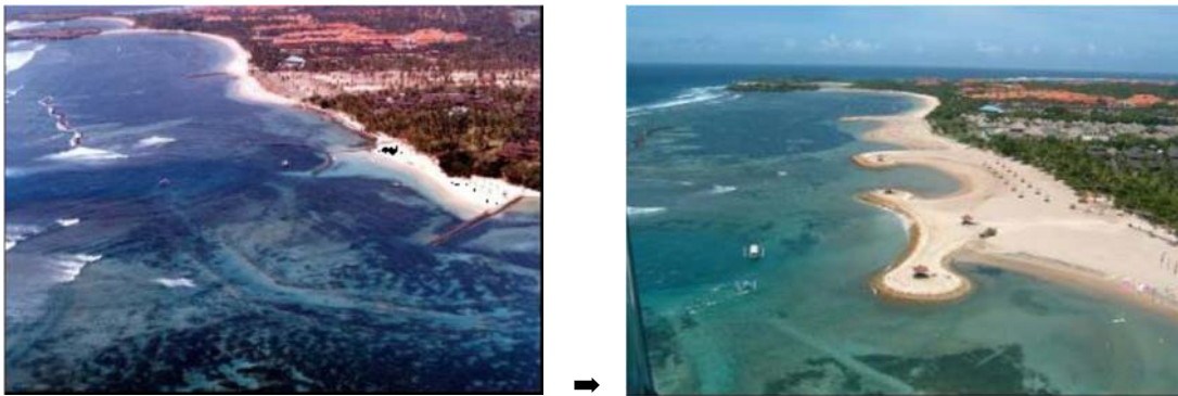
図 4-89 海岸侵食対策のための施設・養浜施工前後の比較 バリ島サヌール海岸
