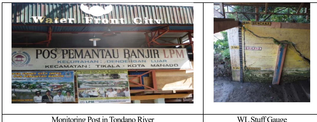
図 4-57 Tondano 川におけるコミュニティによる河川水位の観測所
