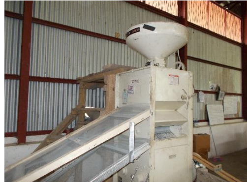
チャクブ組合で使用されている精米機 (機材が古く、精米率が低い)
