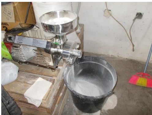
コメ加工品製造のためプロジェクトにより導入さ れた米粉製粉機 (チャクブ組合に設置)
