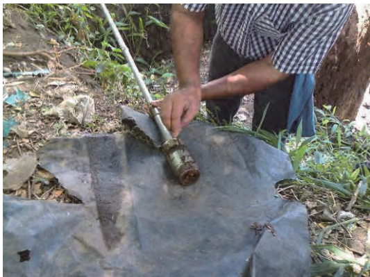
締め固められたPRB 層からの検体採取
