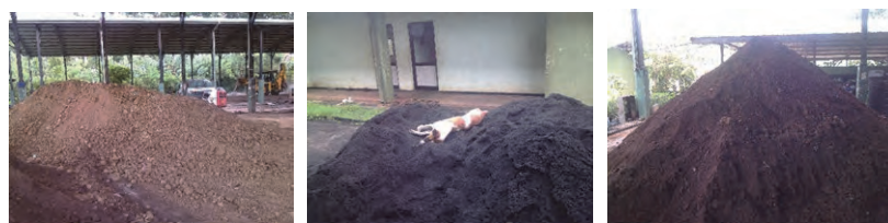
バンガデニアから採取した土12.5% : ココナツ活性炭12.5% : 破碎煉瓦75.0%
