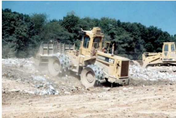
شکل ۸-۱ زباله فشرده شده توسط بولدوزر / فشرده ساز
