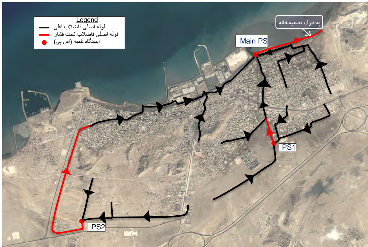
شکل ۷،۳،۱۲ طرح پیشنهادی شبکه اصلی فاضلاب شامل ایستگاههای پمپاژ (تلمبه خانه)
