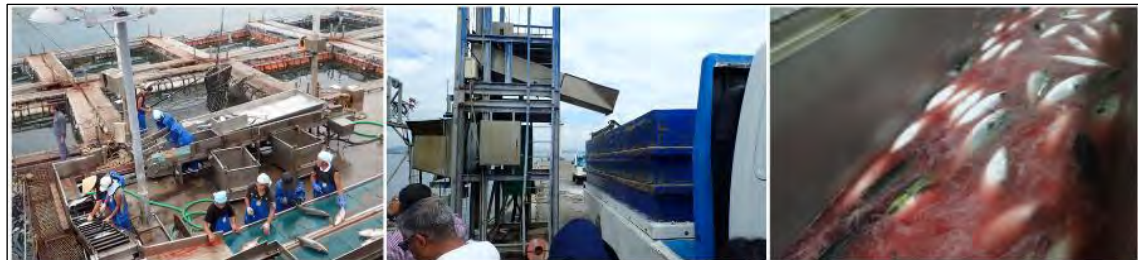
بکامیون حمل و نقل توسط یک ماشین بالبر، راست: انتقال سریع ماهی برداشت شده از کامیون به داخل کارخانه فرآوری ماهی از طریق لوله تخت آب همراه با یخ.
