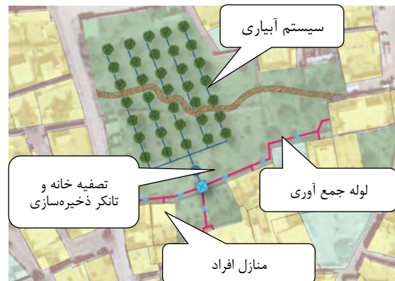
شکل ۷,۳,۸ تصویر سیستم خارج از محل باز مصرف آب خاکستری تصفیه شده
