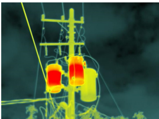
図 9-1-5-1.8 変圧器の温度上昇
