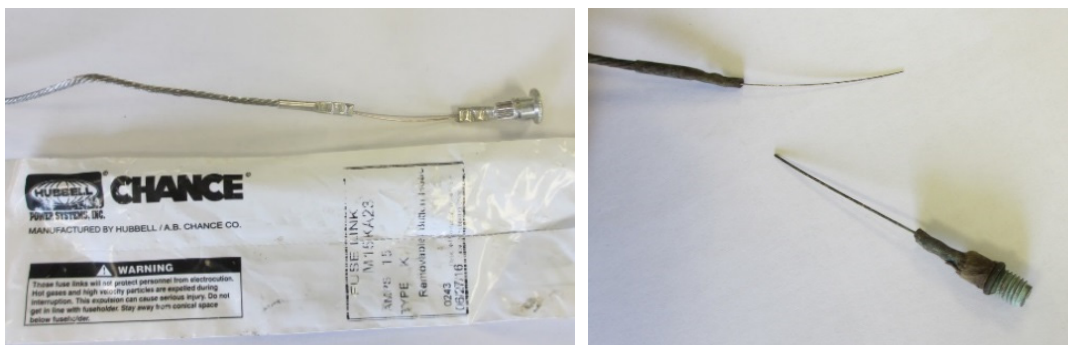
図 9-1-2.7 PPUC の送配電線に設置される保護ヒューズの例 (左 : 新品、右 : 溶断後)
