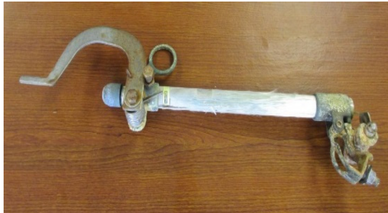
図 9-1-2.6 PC (Primary cutout) ヒューズ筒 (内部にヒューズを取付けて電線路に設置)
