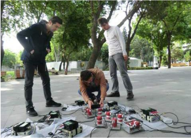
微動計による地盤調査
