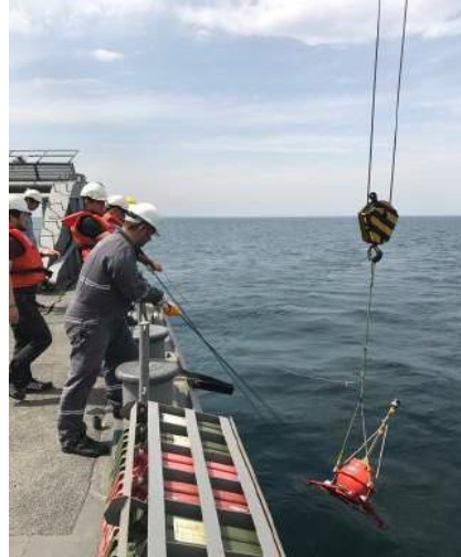
マルマラ海における調査船からの海底地震計 (OBS) 設置作業
