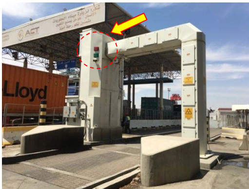
ACT 配備の固定式 X 線検査装置
