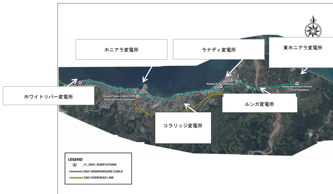
図 2-10 ホニアラ 33kV 送電系統
