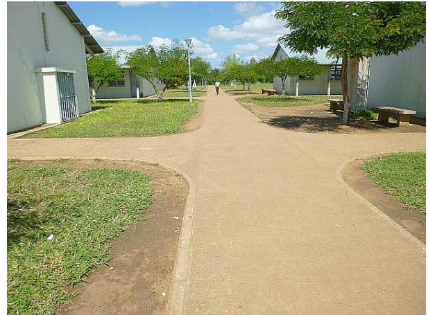
写真 2: 並行配置した建物を中央通路でつなぐ形式。通路は屋根付きではない。
