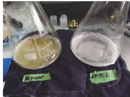
冷媒の再生前後 (左:再生前、右:再生後) (2017年9月)
