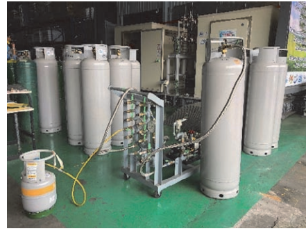
ポンプを用いた冷媒移し替え (2018年3月)
