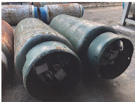
再生ガス保管容器 (R22) (2018年11月)
