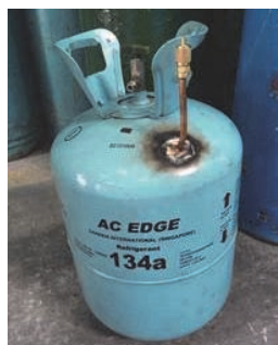
使い捨て冷媒容器に冷媒再充填用の充填口を取り付けた改造容器 (2017年5月)
