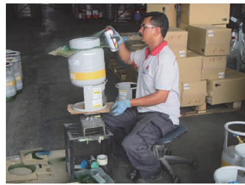
回収容器塗装作業 (2017年7月)
