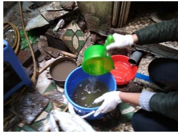
写真 2-8 セプティックタンクからの排水のサンプリング状況 (HN2TR1)
