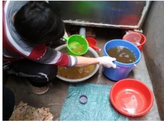
写真 2-6 仮設トイレからの排水のサンプリング状況 (HN2TR1)
