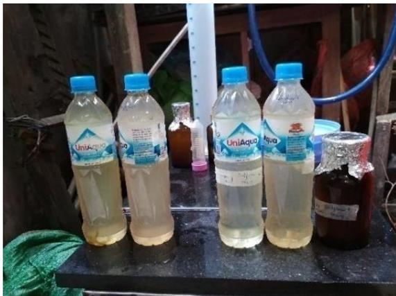
写真 2-9 セプティックタンクの流入水 (左側) と流出水 (右側) の最初のサンプル (HN2TR1)
