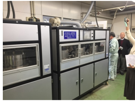
⑭本館：アスファルト抽出試験室
