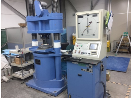
⑬材料試験棟：万能試験機（500kN）
