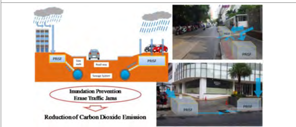
図 6.1 Sukhumvit 地区 Soi39 等におけるプラスチック製雨水貯留構造体による流出抑制策のイメージ
