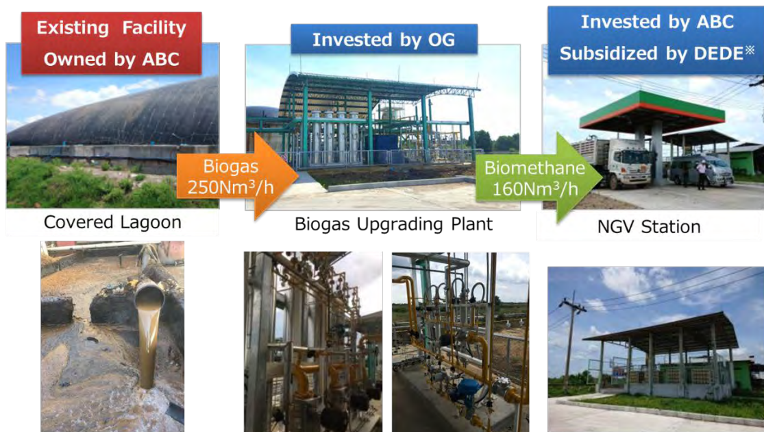
図 6.6 大阪ガス独自のハイブリッド型バイオガス精製システム
