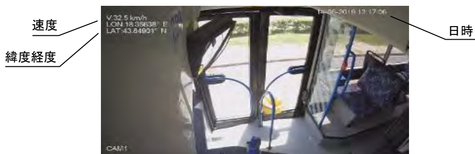
図 3.7.3: CCTV カメラの映像と取得できる情報
