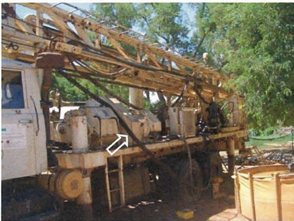
フィードシリンダーチェーン切損事故状況、切損箇所：2014年2月23日
