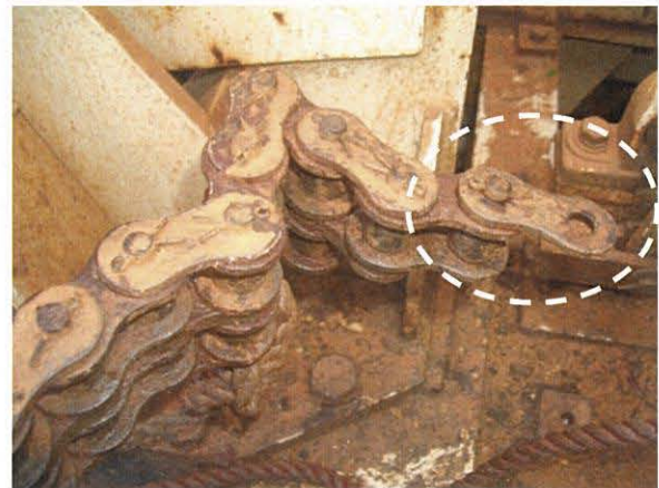
フィードシリンダーチェーン切損事故状況、切損箇所：2014年2月23日
