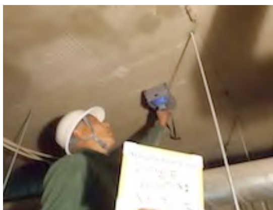
写真㉒：1階図書室床版電磁波レーダー法検査 写真㉓：2階ジャパンプラブ梁同左検査
