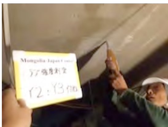
写真⑳：2階ジャパンプラブ床版圧縮強度試験 写真㉑：2階ジャパンプラブ梁圧縮強度試験
