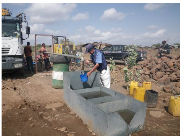
写真 11：揚水試験の実施状況（ウェデラゲ）
