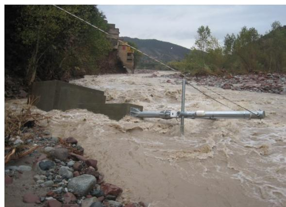
写真 1.1.1 倒壊前の水位計（2013年7月） 写真 1.1.2 倒壊した水位計（2014年11月）
