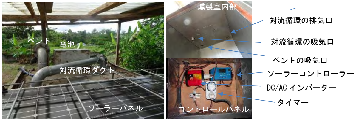
図 31 太陽光を利用した燻製炉上部の対流熱循環装置
