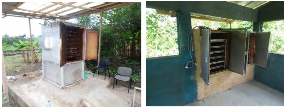
完成した可動式 (左) と設置式 (右) の PREPICO くん製炉
