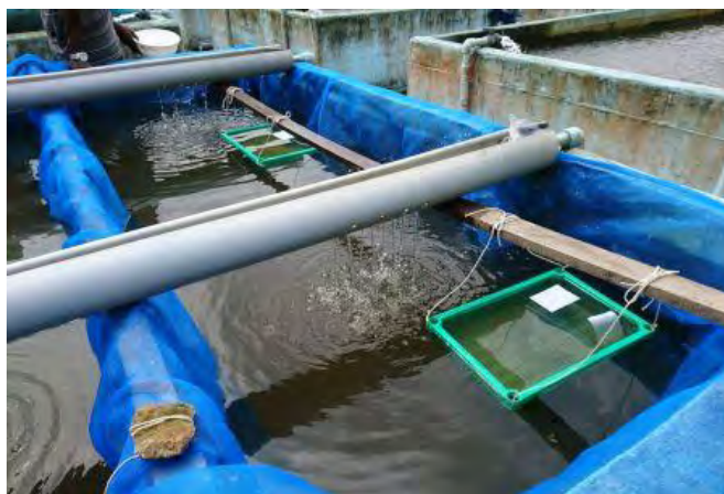
図 2 ハイブリッド式の種苗生産システム (Hatching tray 内にて受精卵・卵黄吸収期の孵化仔魚を飼育、 Partitioning hapa 内にて卵黄吸収後の浮上仔魚を飼育)
