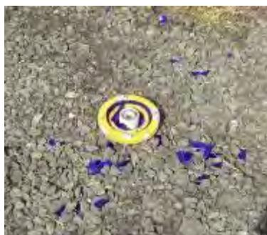
写真 2-1-4. 14 破損した誘導路灯器
