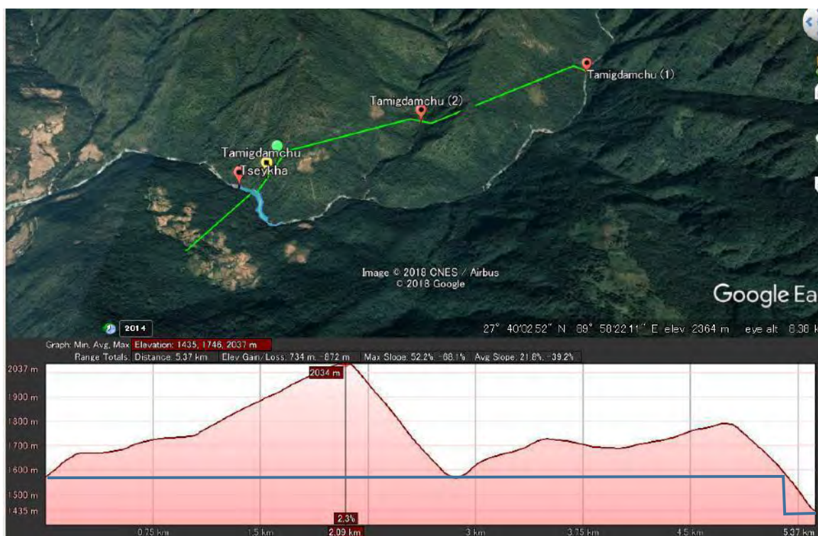
図 A 1-14 水路縦断面図 (P-15)
