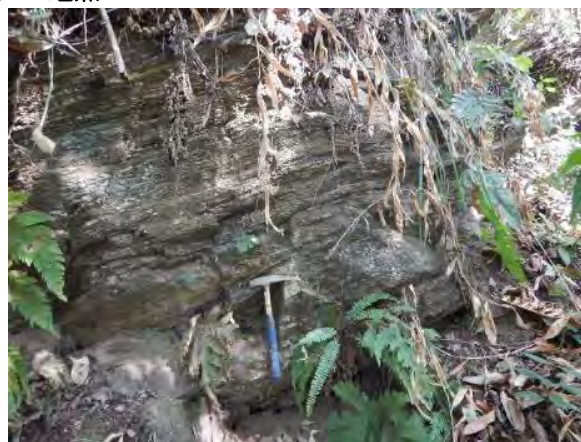
Photo 3 堅岩の構造 (NW-SE 走向, N 傾斜)
