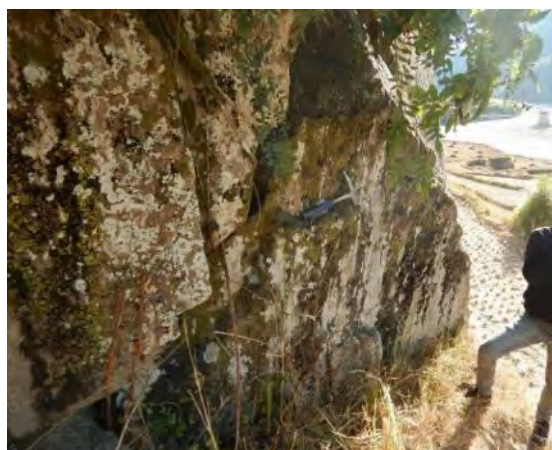
Photo 11 発電所近傍の移動岩塊 (片麻岩)
