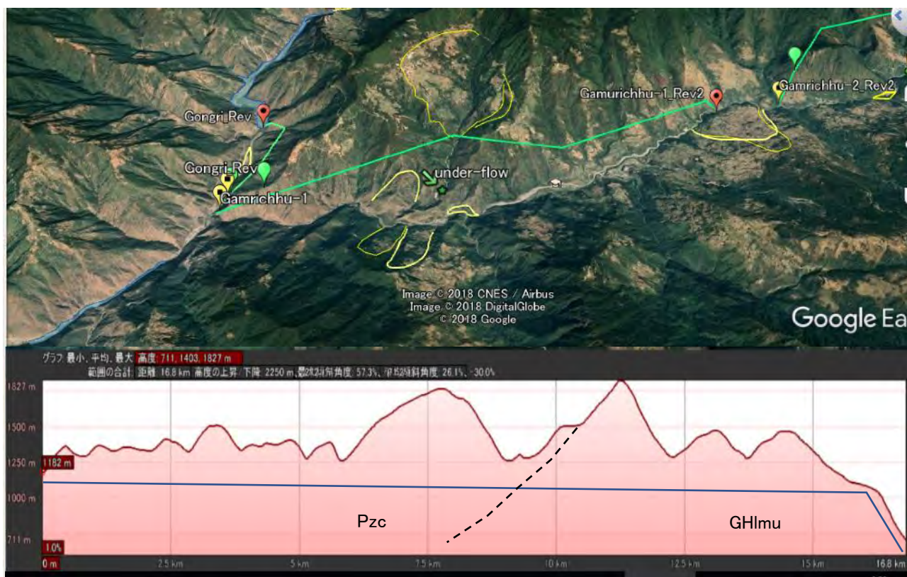
図 A 1-66 水路縦断面図 (G-11_Rev2)
