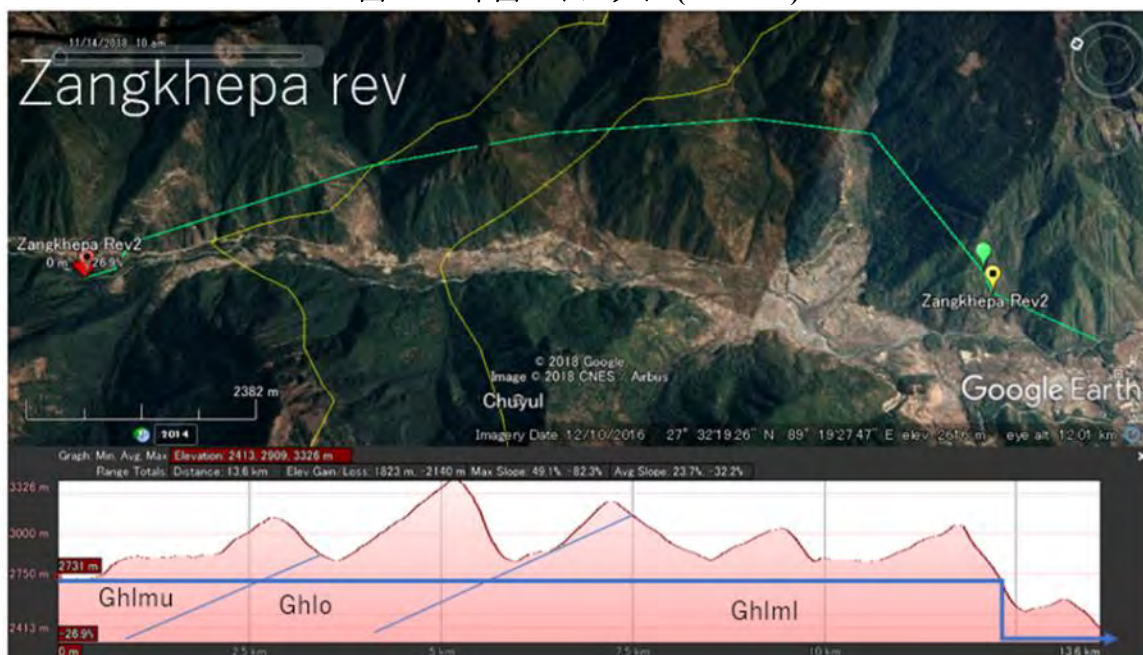
図 A 1-10 水路縦断図 (W-8 Rev)
