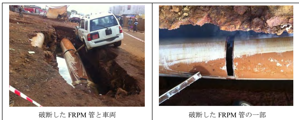
図 4-8 第 10 回目破断（2014 年 5 月 19 日）
