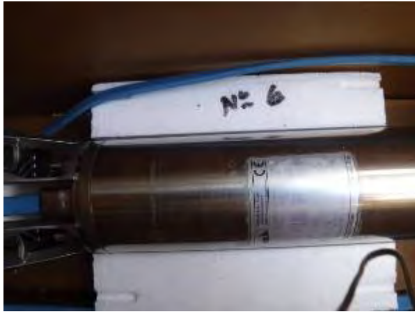
FK3-bis2 用 水中モーターポンプ 10m 3 /h×40m×2.2kW
