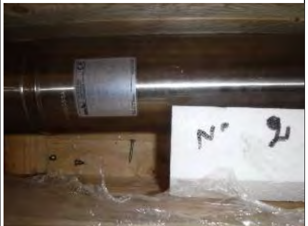
F8 用 水中モーターポンプ 70m 3 /h×50m×15.0kW
