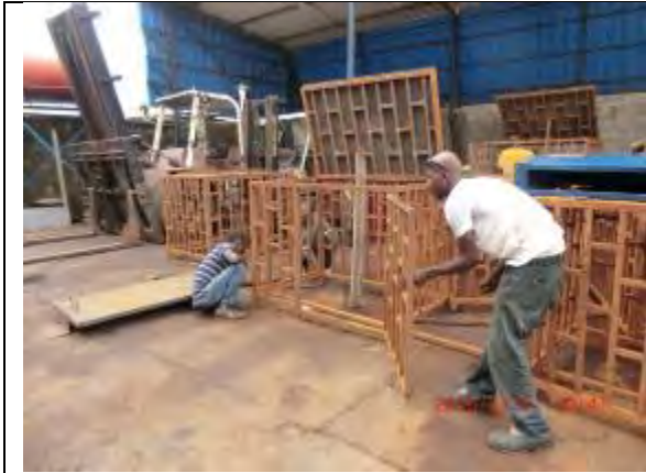
7. GTF 工場 発電機柵の錆び止め塗装前の表面 処理作業 撮影：2016年7月18日
