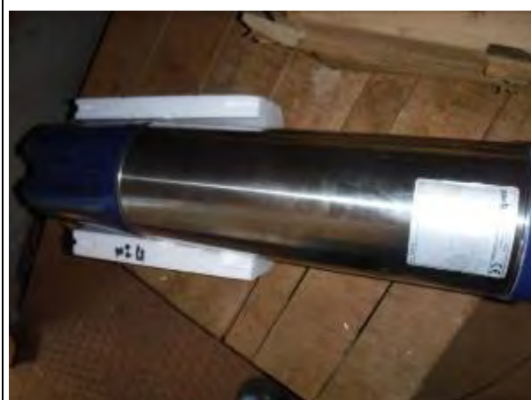
FK1-bis1 用水中モーターポンプ 25m 3 /h×40m×4.5kW
