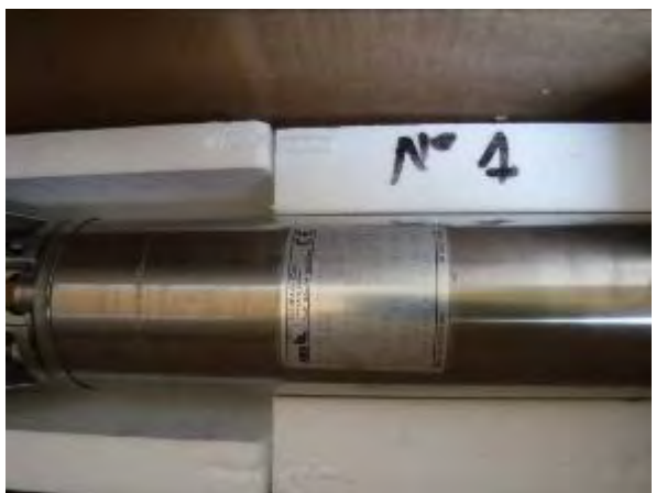
F7 用 水中モーターポンプ 16m 3 /h×45m×3.7kW
