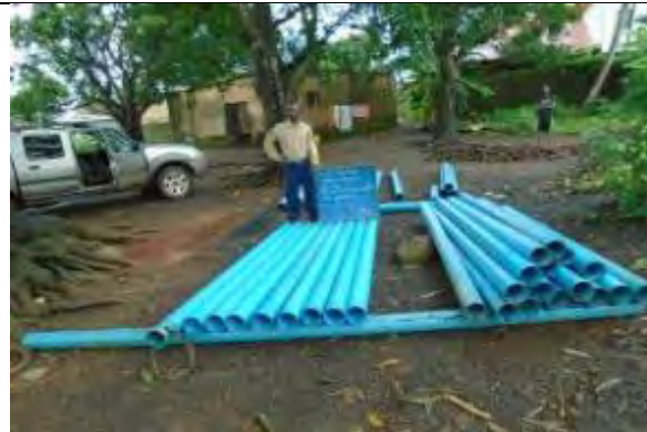
3. No2 Près de chez Fofana Syndicat PVC 製ケーシング検査 撮影：2015年8月28日
