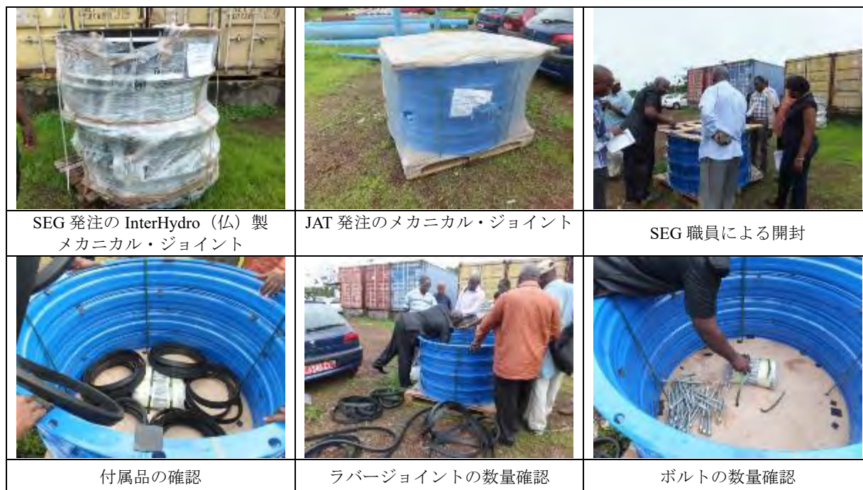
図 4-7 メカニカル・ジョイント納品検査 (2014 年 6 月 24 日)
