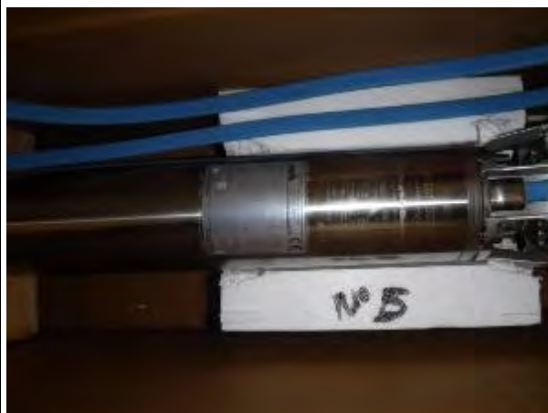
FK3-bis1 用水中モーターポンプ 10m 3 /h×40m×2.2kW
