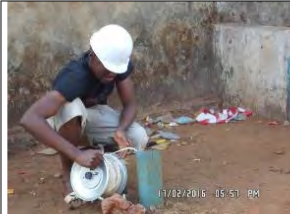
1. No.12 Carrefour Berlie 揚水試験 水位測定 撮影：2016年2月17日
