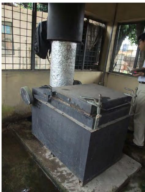
写真7 CPHL 焼却炉。行政による焼却灰、医療廃棄物の回収は行われておらず。構内で埋設処理している。
