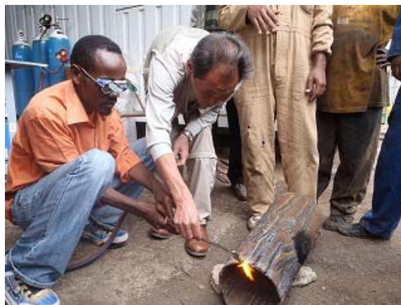
ガス切断の実習の様子（講師の指導を受ける研修生）
