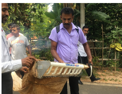
動力式茶葉刈取機は2人で作業する （JICA 調査団撮影）
