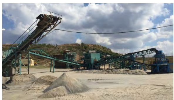
骨材生産プラント (1000t/日) 25km 付近ナテンジェ付近に複数の砕石場が操 業している。
