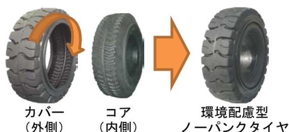
図-i フクナガエンジニアリングによるタイヤ再利用のイメージ
