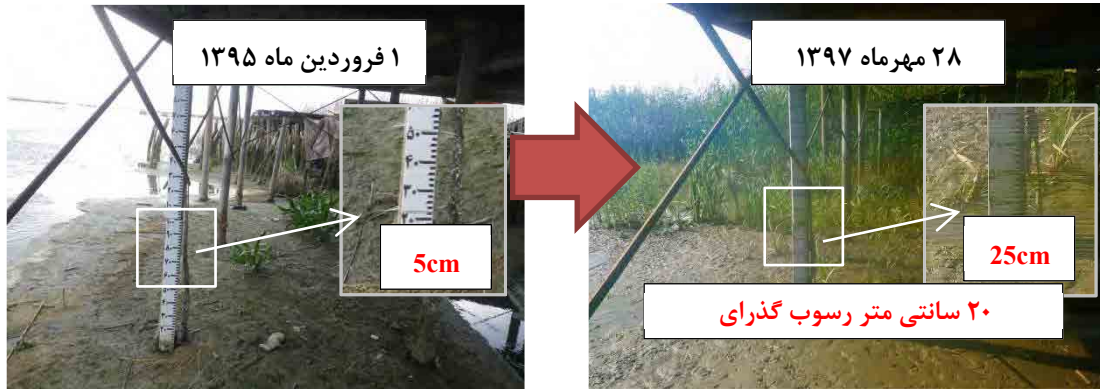
تصویر ۳-۲-۱۹ ثبت انباشت رسوبات در پاسگاه محیط بانی سرخانکل به وسیله دوربین های عکس برداری متناوب
