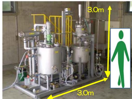
図 3.2 大阪府立大学にある類似の BDF 製造装置(反応槽 100ℓ)(JICA 調査団作成)
