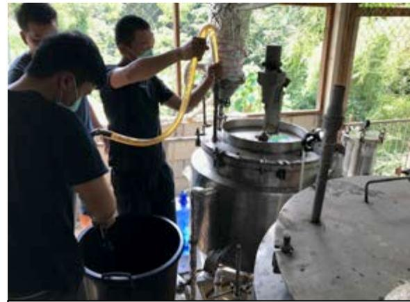
写真 10. 原料油の反応槽への投入
