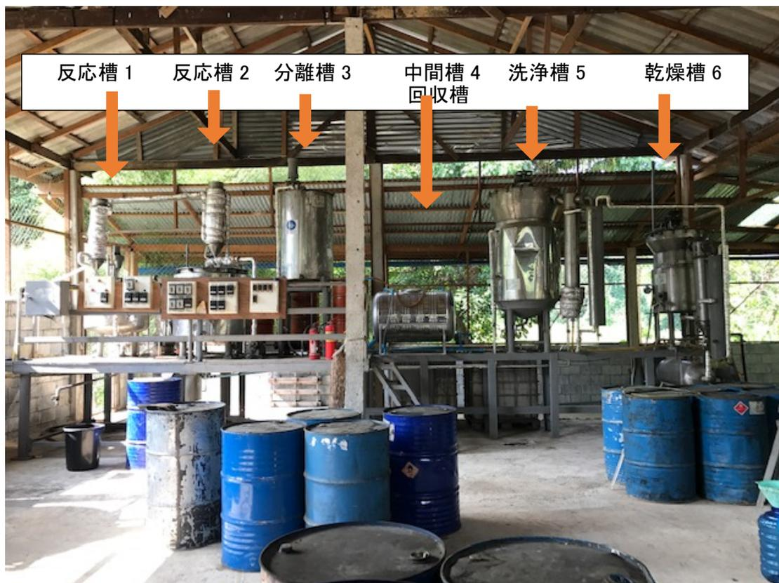
写真 1. Makkau 社の BDF 製造装置
