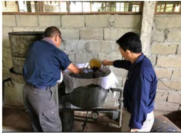
写真 8. 搾油した油のフィルター作業
