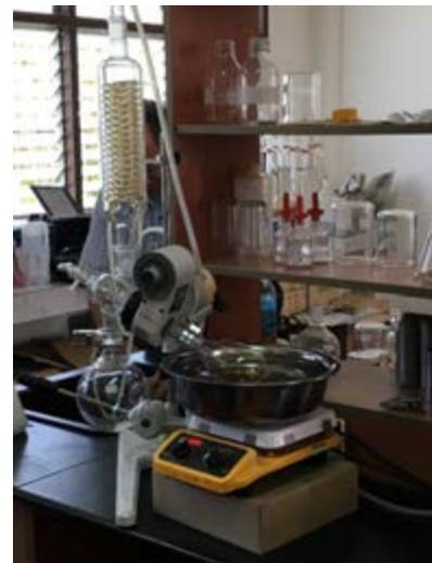
写真 4.8 薬品を蒸発させて純粋 BDF の精製
