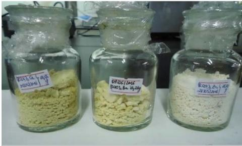
図 2.4 広東アブラギリ油から製造した金属石鹼（左からカルシウム、バリウム、亜鉛）
