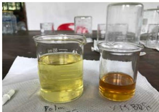
写真 18. プラント装置で製造した BDF の最終製品 (乾燥済) (左: パーム油 BDF、右: 広東アブラギリ油 BDF)
