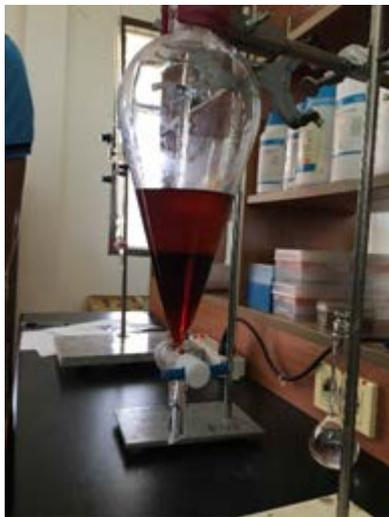
写真 4.7 薬品が混在した BDF
