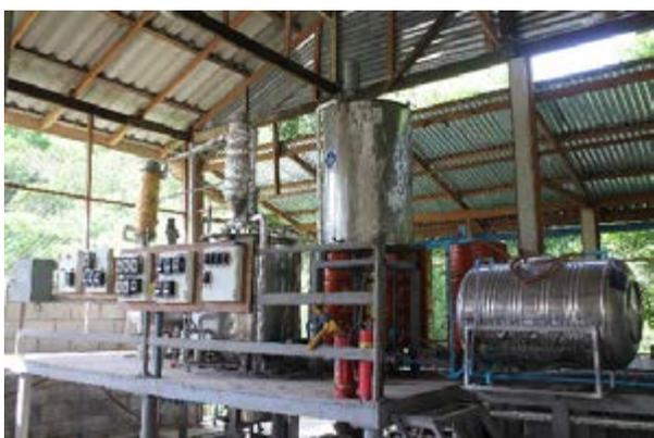
写真 4.13 BDF 製造装置、反応容器(容積 200ℓ)
