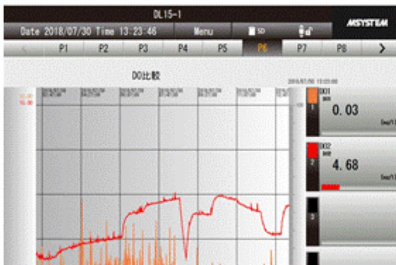
写真6：曝気槽第1.2槽のDO計のトレンド
