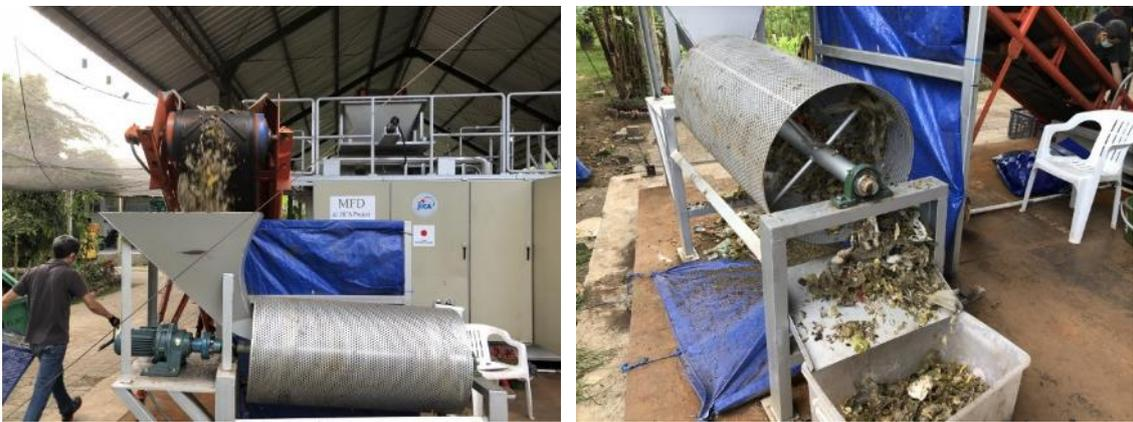
図 20 トロンメルを使用して、アウトプットから有機ごみ以外を除去する
