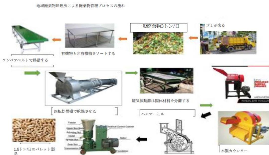
図 13 RDF（廃棄物固形燃料）設備の処理フロー
