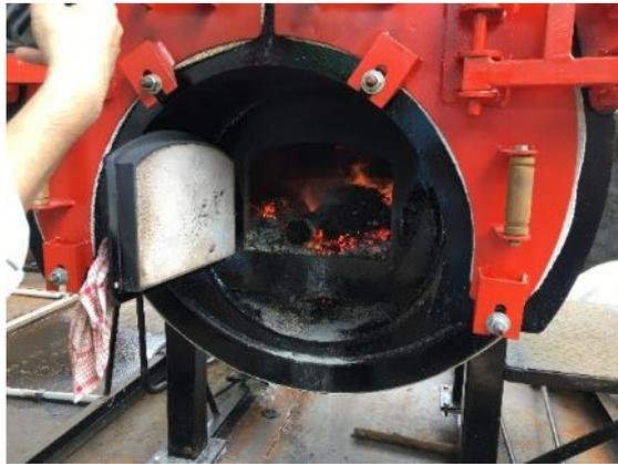
図 34 アウトプットを試験的にボイラーで燃焼させる実験
