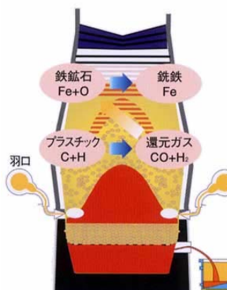
【図 3-6：高炉還元剤の原理】
