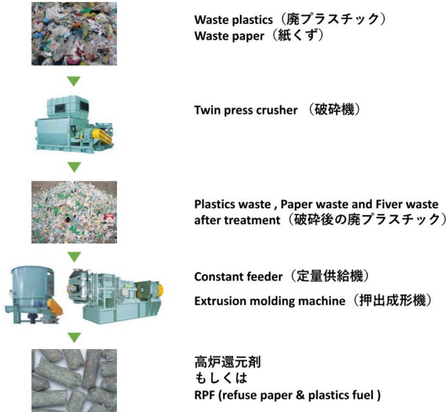
【図 3-5：高炉還元剤の生産フロー】
