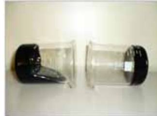
アスファルト材料 (左:ストレートアスファルト 右:改質アスファルト)
