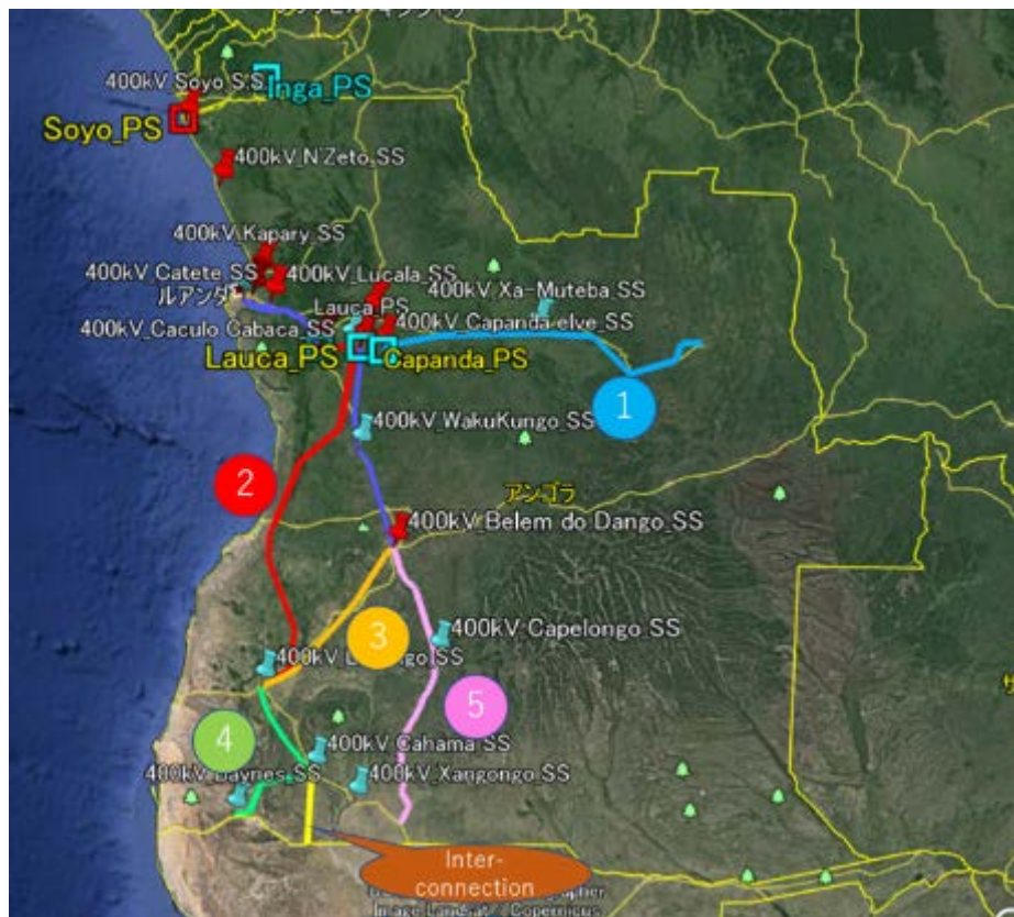
図 11-27 SEA 実施対象送電線 (5+1 ルート)
