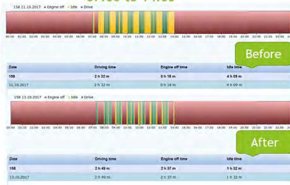
図 3-16 アイドリングストップ実施前と実施後のアイドリング時間の差異
