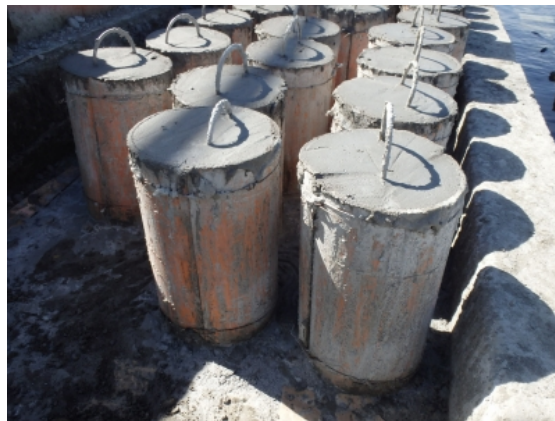
網用の沈子（コンクリート製：空中重量20kg）
