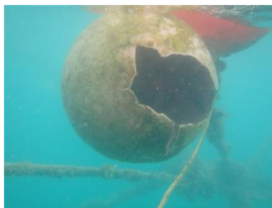
台風ウルドゥハの影響で傾いた監視小屋と割れて水中に沈んだフロート
