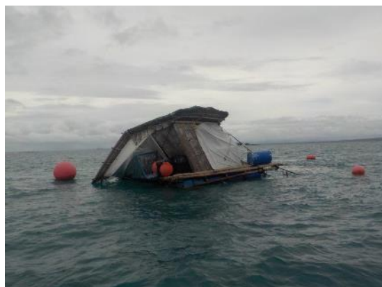
台風ウルドゥハの影響で傾いた監視小屋と割れて水中に沈んだフロート
