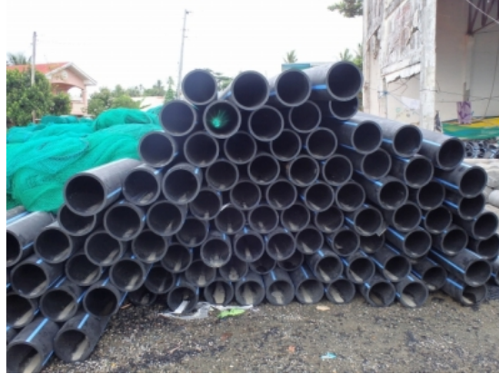
外径225mmのHDPEパイプ（フィリピン製）
