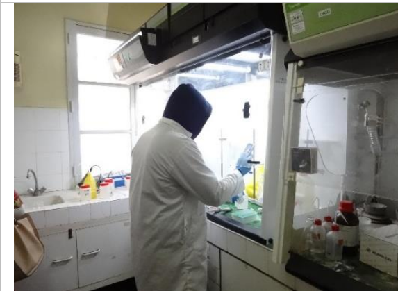
検査風景。クリーンベンチは老朽化し、安全性が懸念されている。
