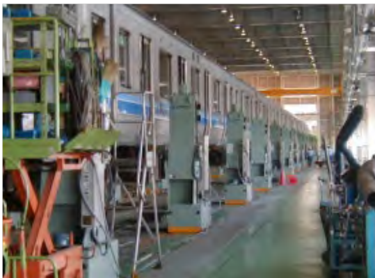
図 4.10.5 全部の車体を同時にあげたまま 部品の検査を行う
