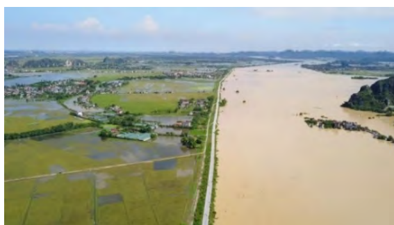
堤防天端付近まで上昇した洪水位 Hoang Long 川 (Ninh Binh 省)
