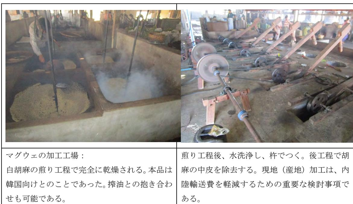
図 19 胡麻油以外の輸送効率化に資する現地加工の例
