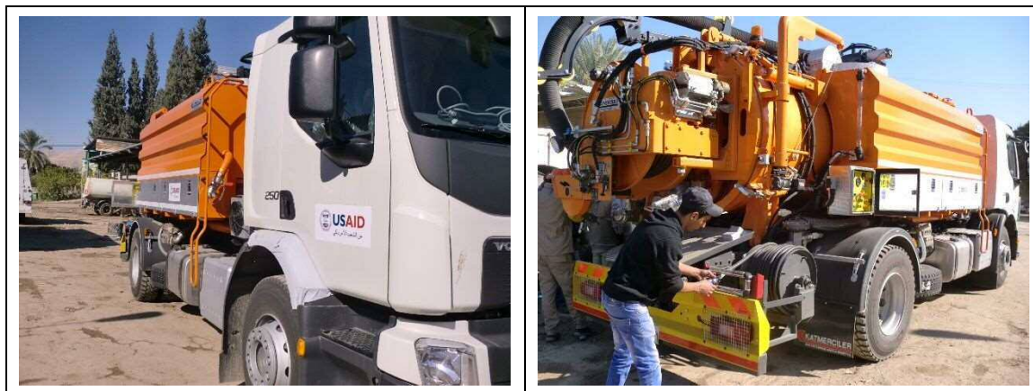
図 2.19.1 USAID より供与された下水管路清掃機材
